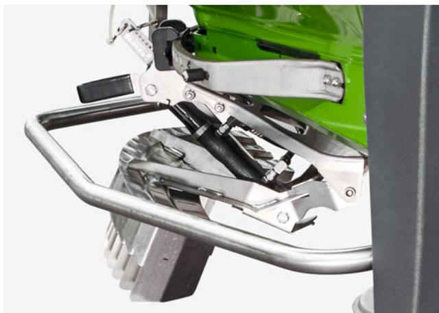
Dispositivo di concimazione di confine idraulico Limiter V
