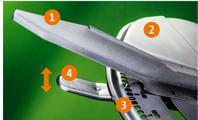
① Paletta di spargimento, ② Corpo del disco di spargimento, ③ Posizioni chiare della scala, ④ Sistema di regolazione QuickSet per impostare la posizione delle palette
