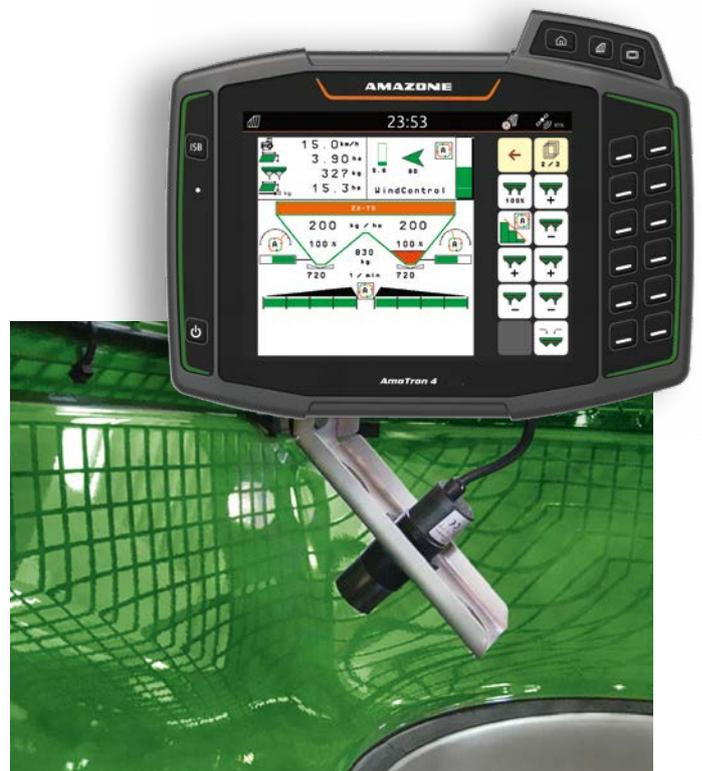
✔ Sensore di livello del fertilizzante nello ZA-TS
