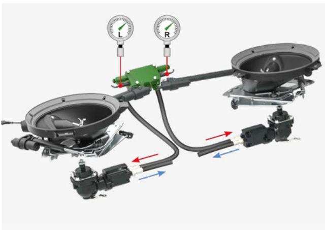
✔ Sensori FlowCheck nel circuito idraulico
