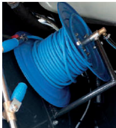
Avvolgitubo con lancia per pulizia semovente a 15 bar. Collegato con la pompa dell'acqua, utilizza l'acqua pulita del lavacircuito.
