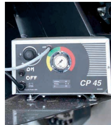
Compressore aria per una pulizia del motore, dei radiatori e tutte le parti che lo necessitano.
