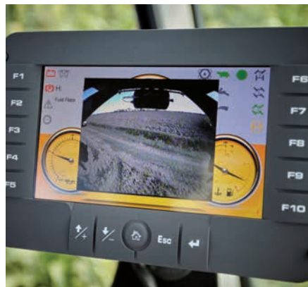
Telecamere anteriori e posteriori, per visualizzare le immagini sul display TERA.
