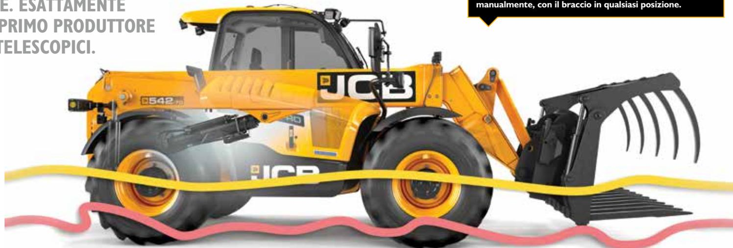
Il sistema antibeccheggio automatico (SRS) si attiva a velocità superiori a 4 km/h. In questo modo si migliorano la ritenzione del carico e il comfort (e di conseguenza la produttività) durante i trasferimenti a velocità sostenute su strada e campi. Il sistema può essere attivato manualmente, con il braccio in qualsiasi posizione.
