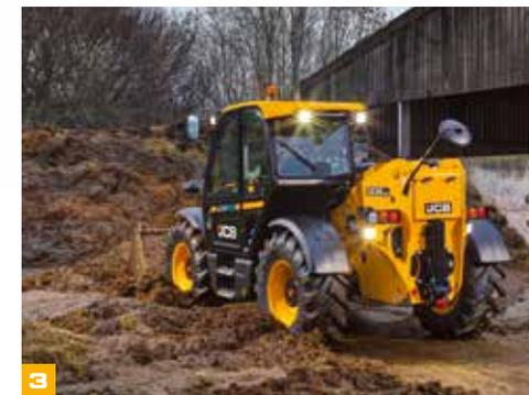
**4** I movimentatori telescopici Agri offrono la possibilità di selezionare tre modalità di sterzata. Ci sono due ruote sterzanti, l'ideale per i trasferimenti su strada ad alta velocità; quattro ruote sterzanti per operare in spazi ristretti, mentre la sterzata a granchio è consigliata per le manovre in prossimità di muri e negli edifici agricoli.
