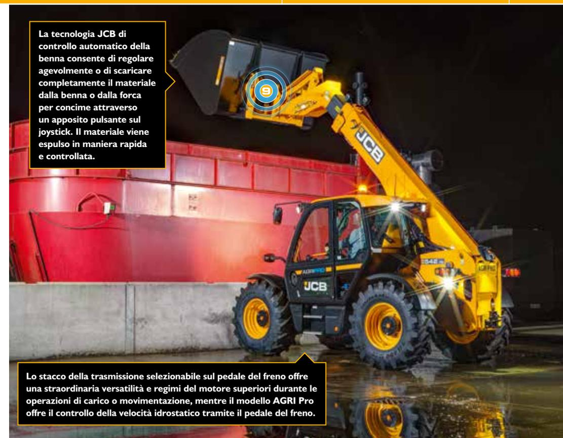
La tecnologia JCB di controllo automatico della benna consente di regolare agevolmente o di scaricare completamente il materiale dalla benna o dalla forca per concime attraverso un apposito pulsante sul joystick. Il materiale viene espulso in maniera rapida e controllata.
