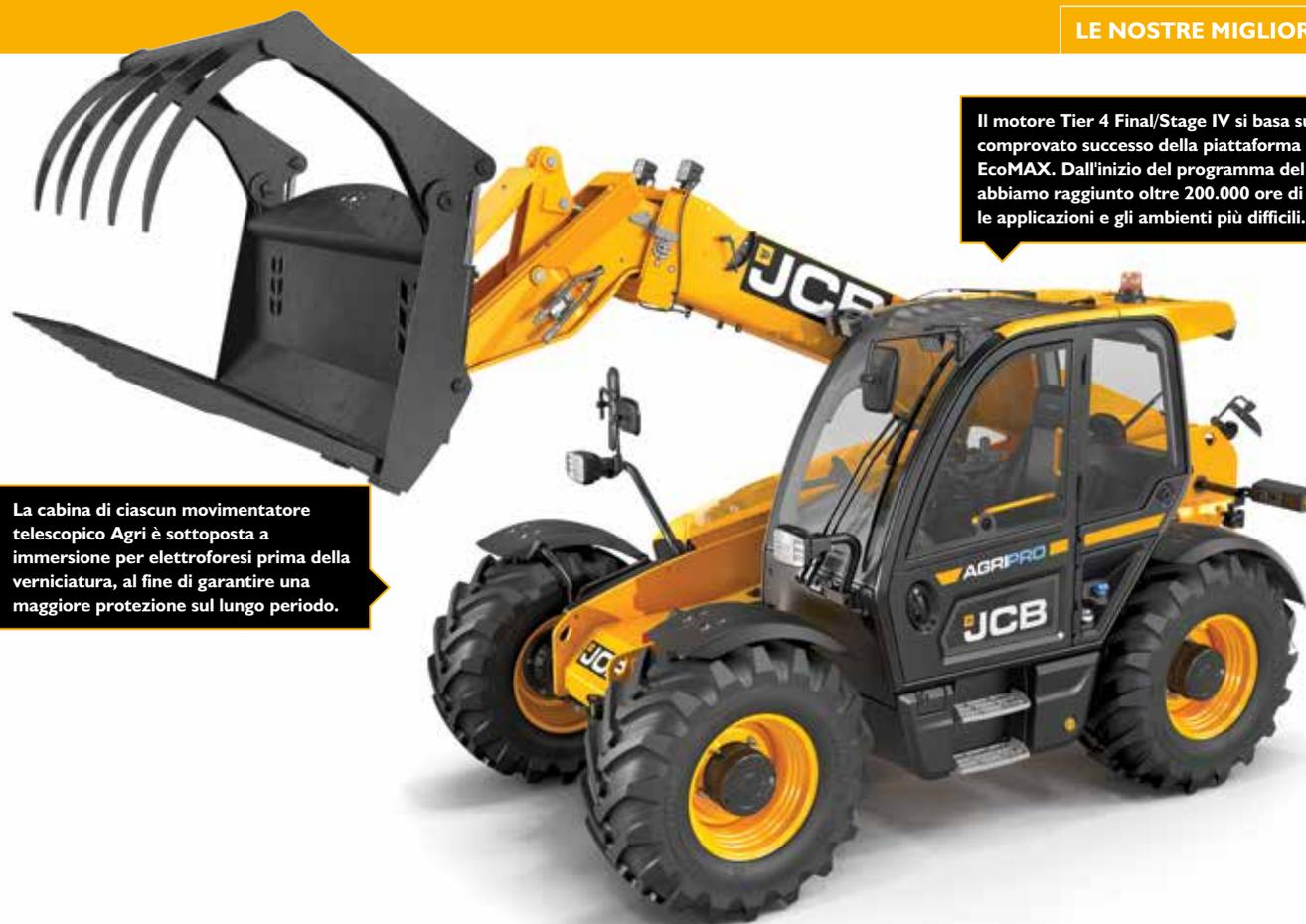
La cabina di ciascun movimentatore telescopico Agri è sottoposta a immersione per elettroforesi prima della verniciatura, al fine di garantire una maggiore protezione sul lungo periodo.
