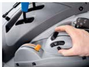
Il mouse ergonomico del sollevatore elettronico permette di regolare facilmente lo sforzo e la profondità di lavoro.
