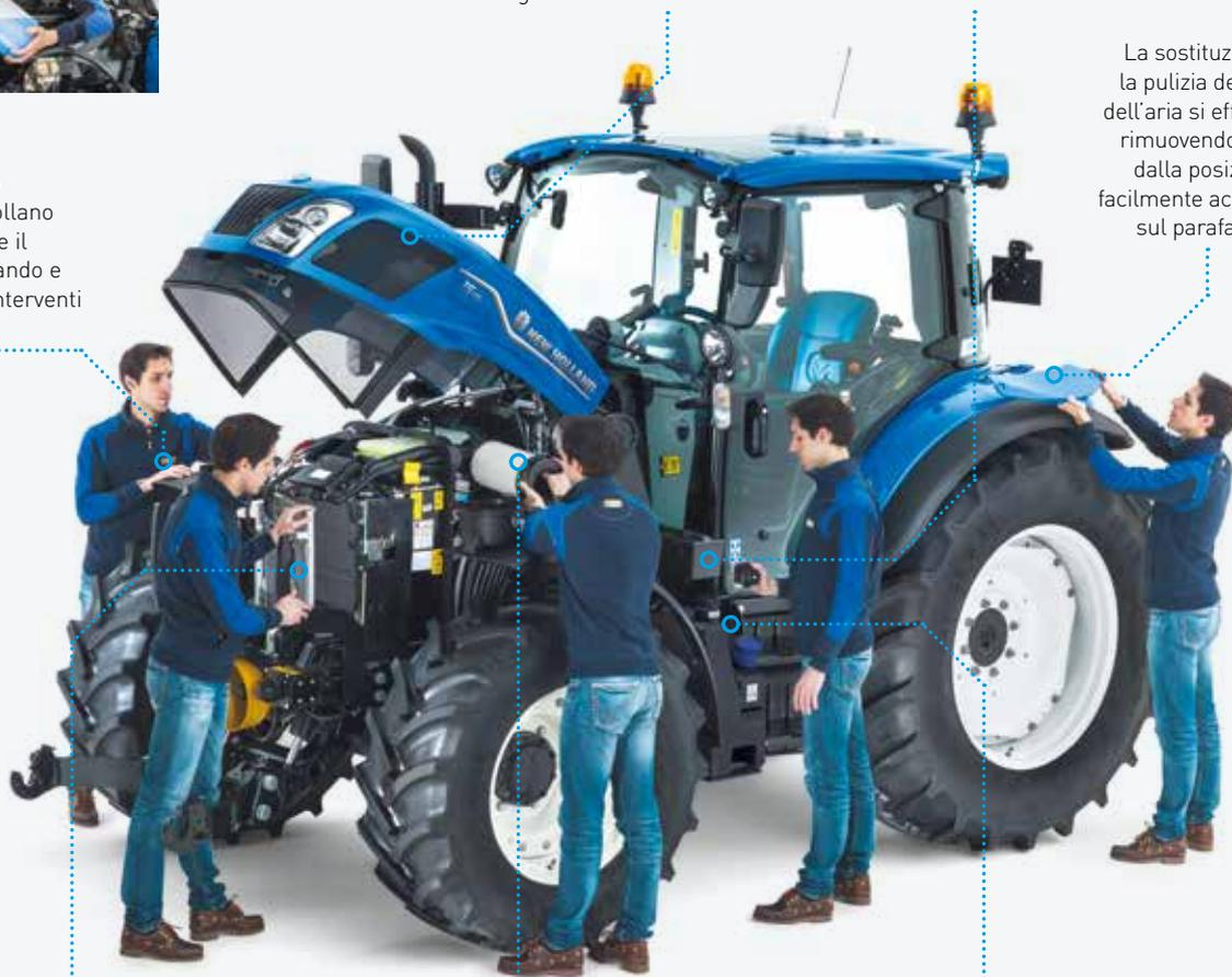
Il modulo di raffreddamento si estrae tramite una guida scorrevole e può essere pulito in modo rapido e semplice.
